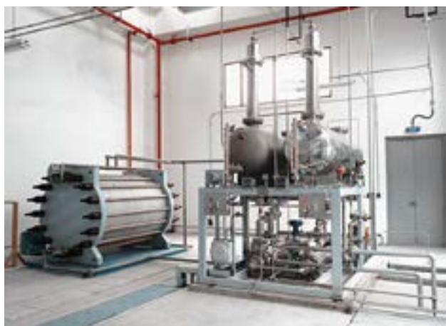
50m 3 /h 电解水制氢设备
