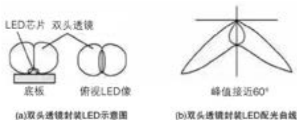
图 3：双头透镜封装的 LED 配光结构和配光曲线示意图
