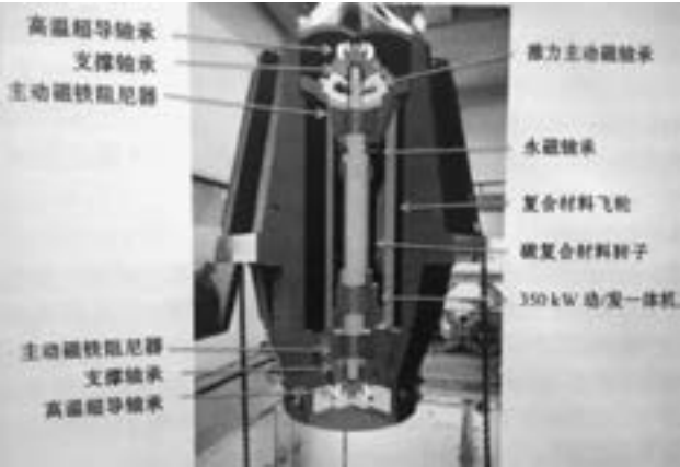
飞轮储能装置的内部结构
