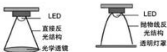
图 6：外置透镜和反光器的 LED 示意图
