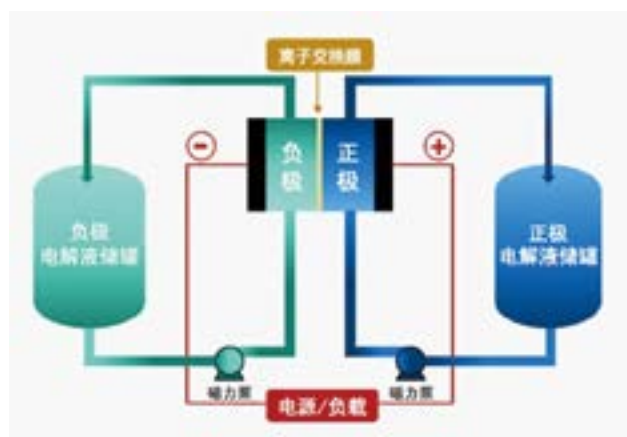
液流电池工作原理
